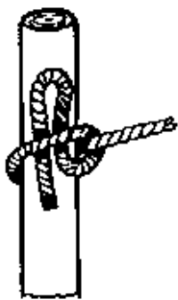
Slipstek öffnet sich bei Zug an einem Ende selbst
